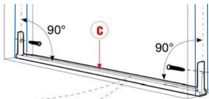
Attention : en revissant, bien positionner le T vertical pour permettre le mouvement libre de l'équerre.
