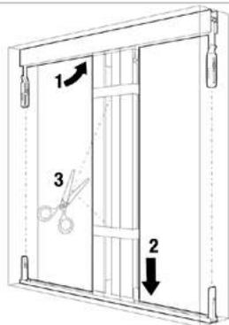
Les cordons doivent être parfaitement positionnés afin d'avoir un fonctionnement correct et éviter toute résistance ou blocage et une usure prématurée à l'utilisation.
