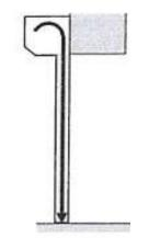
Si le tablier est livré monté dans le caisson (LB maxi 2500 et HB maxi 2000) faire descendre le tablier dans les coulisses jusqu'en bas.
