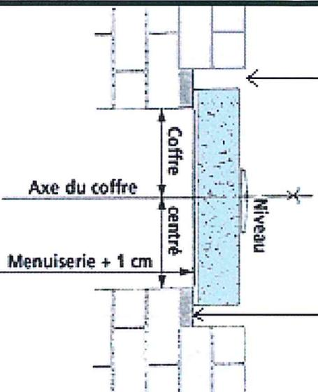
Etayer correctement le coffre avant de couler le chaînage, ou le linteau ou la dalle
