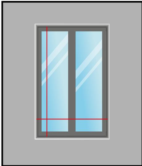
2. Vérifiez que les dimensions de l'endroit de pose correspondent bien à celles du volet roulant (coffre + coulisses).
