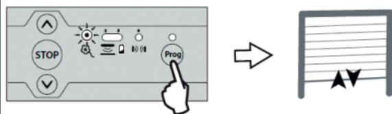
g. Appuyer simultanément sur **PROG** jusqu'au mouvement de va et vient pour sortir du mode réglage moteur.
