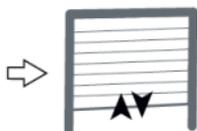
a. Appuyer simultanément sur les touches **MONTÉE** et **DESCENTE** jusqu'au va et vient du moteur.
