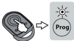
c. Appuyer sur une touche de la commande Keygo à mémoriser dans un délai maximum de 10 sec. Le voyant au-dessus de la touche Prog du boîtier Rollixo clignote, la commande est mémorisée dans le récepteur.
