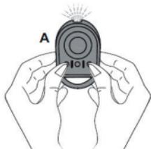
b. Appuyer sur les touches extérieurs **DROITE** et **GAUCHE** de la commande Keygo. Le voyant de la commande clignote rapidement.
