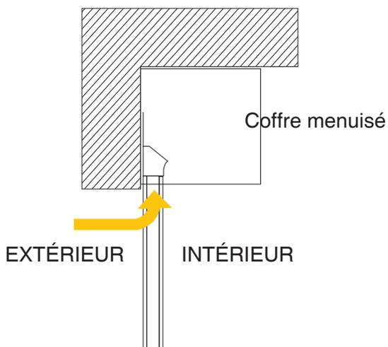
③ Insérer les coulisses dans le coffre, par l'extérieur en respectant le sens droite et gauche.
